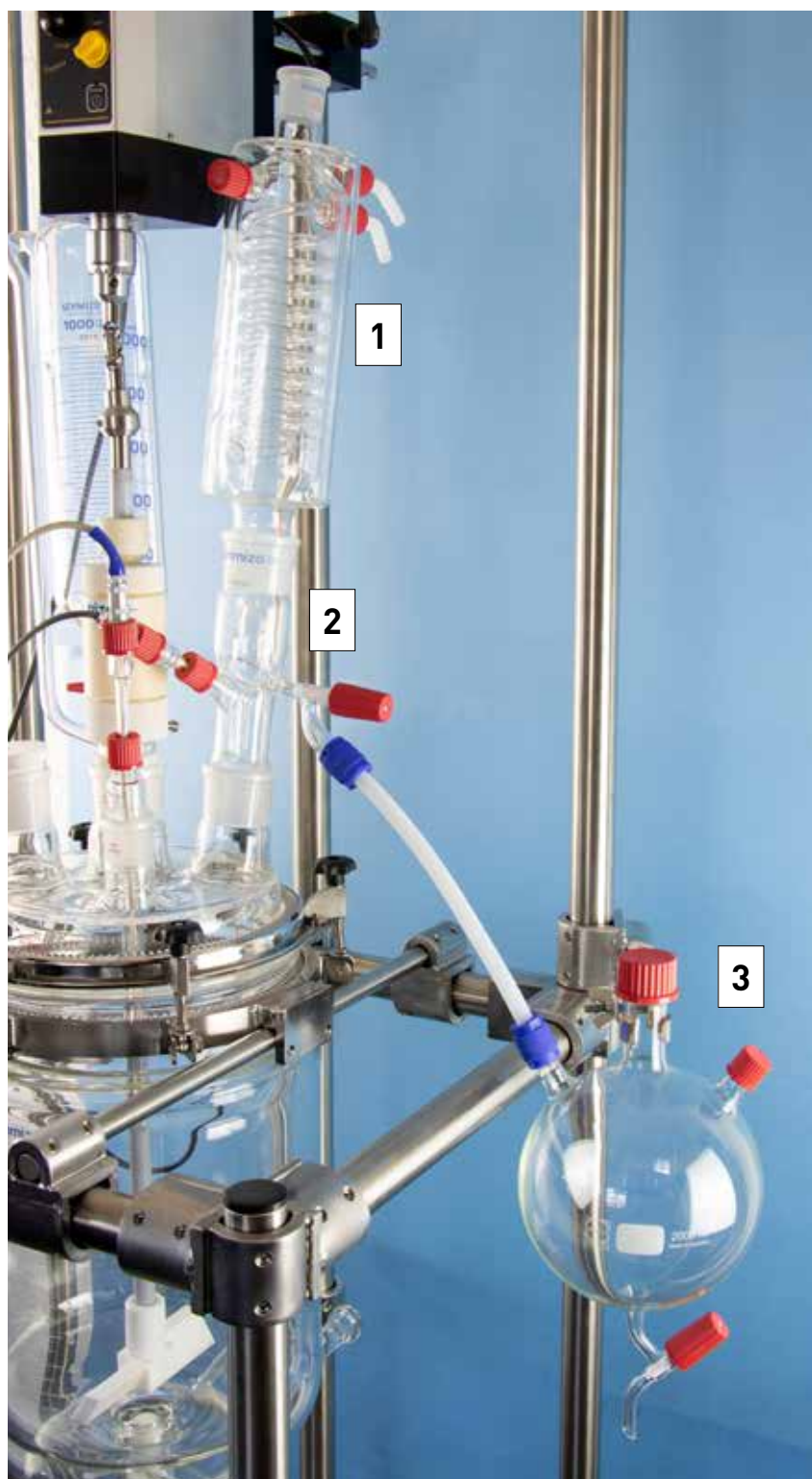
Destillationsaufbau mit Intensivkühler, Flüssigkeitsteiler und Auffanggefäß
