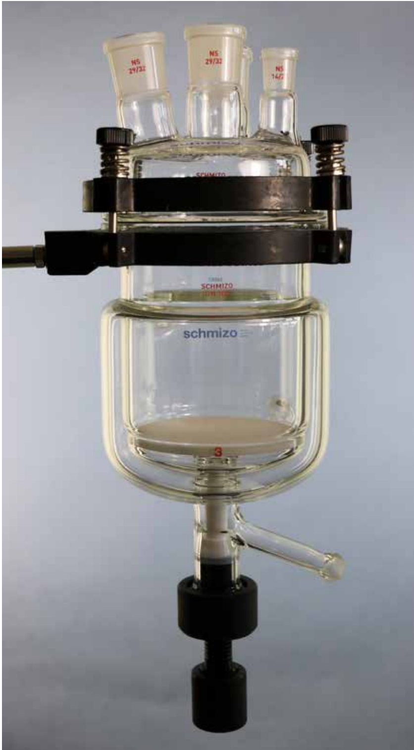
Doppelmantel-Reaktor mit eingeschmolzener Glasfilter-Platte P3
